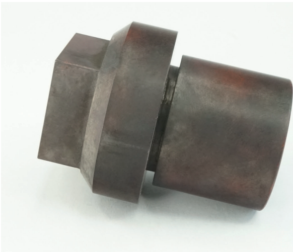
1 Rohteil/Fertigteil – dazwischen liegt die Hartbearbeitung schwer zerspanbarer Werkstoffe © Hardinge
